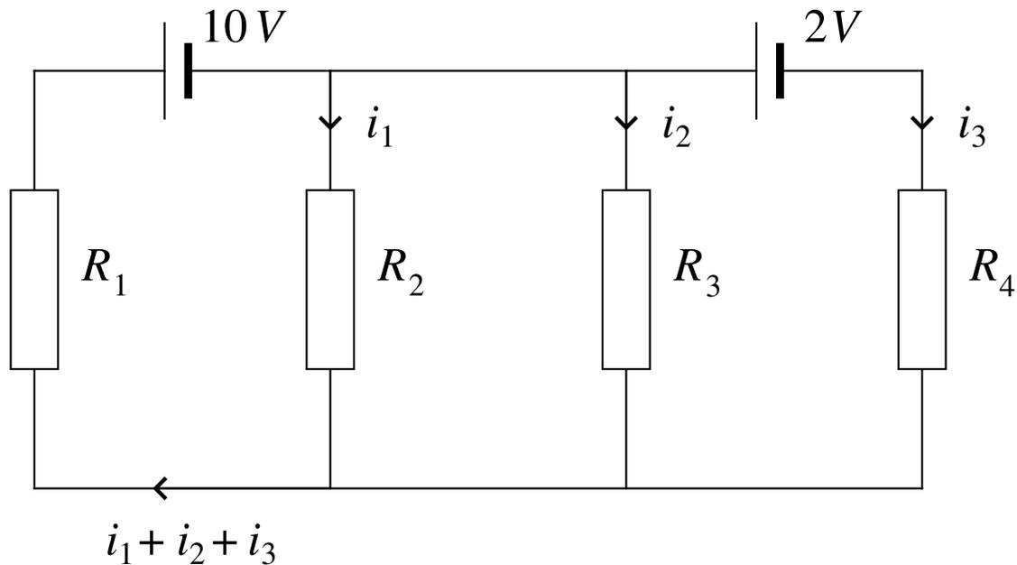
$$R_2 i_1 + R_1 (i_1 + i_2 + i_3) = 10V,$$
